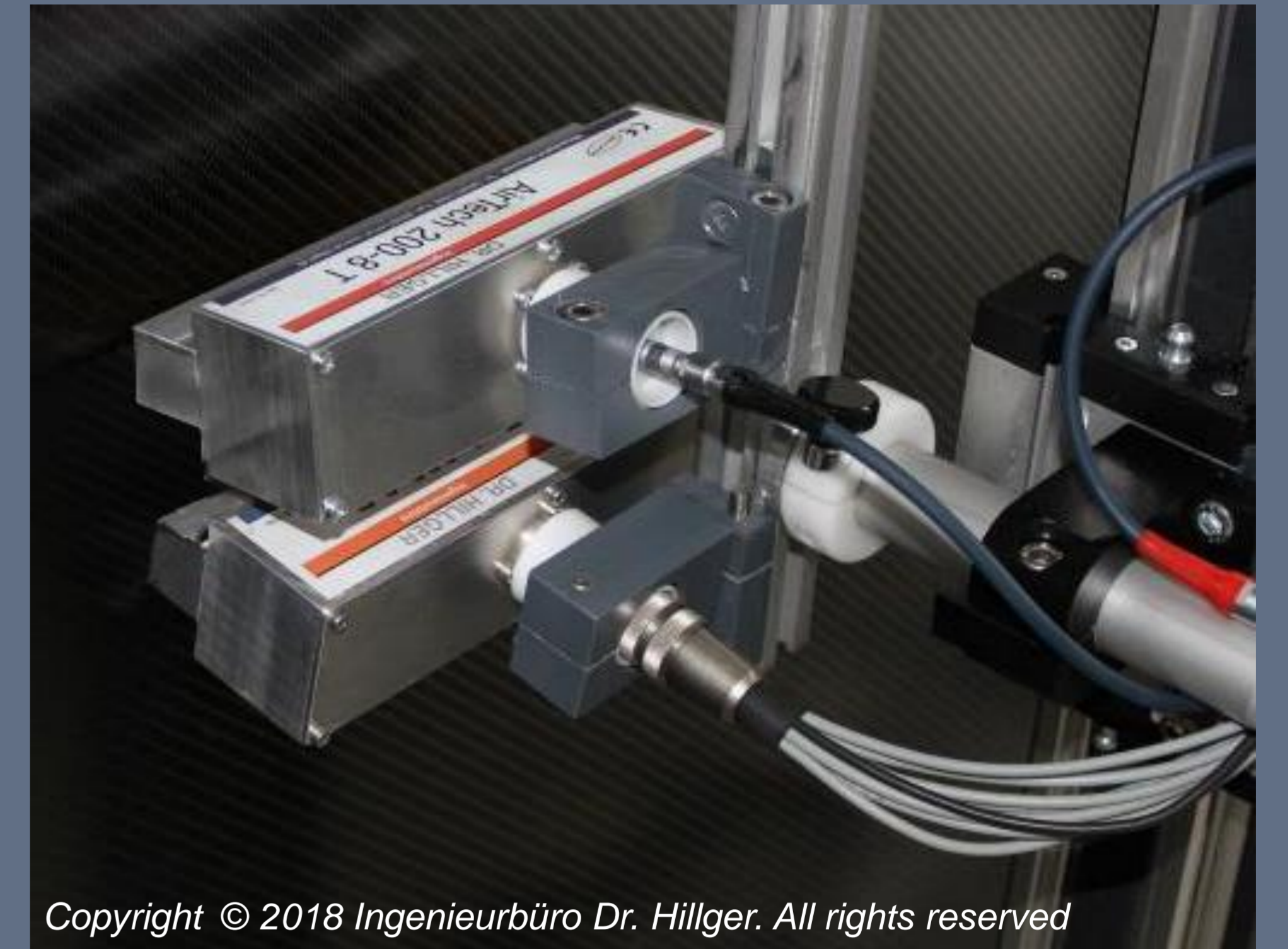
Bild 2: Einseitige Prüfung mit V-Anordnung der Arrays
