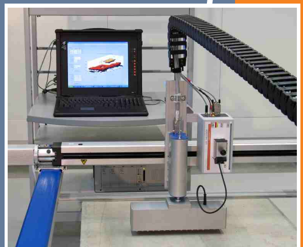
Komponenten Flexus Beton: Ultraschallprüfgerät, Prüfkopf-Array, Multiplexer, Scanner mit Steuerung
