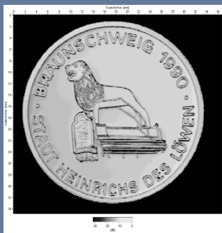
C-Bild einer Münze aufgenommen mit 80 MHz
