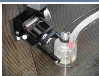
Kardanisch befestigter Prüfkopfadapter mit eingebautem focussierten Tauchtechnikprüfkopf
