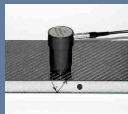
Impuls-Echo-Prüfung einer CFK-Sandwich-Probe mit Schaumkern
