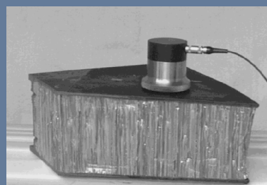
Impuls-Echo-Prüfung einer CFK-Sandwich-Probe mit Aluminium-Waben
