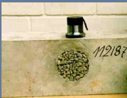
Betonprobe mit Kiesnest und Impuls-Echo-Prüfkopf
