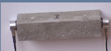
Prüfung einer Mörtelprobe in Durchschallung zur E-Modul-Bestimmung
