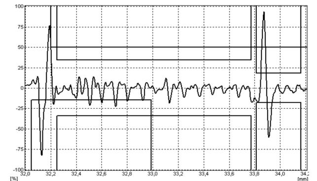
**Abb. 3:** A-Bild eines 2 mm dicken CFK-Testkörpers
