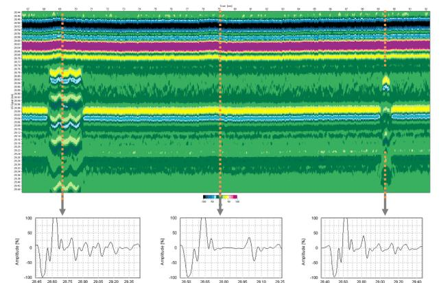
**Abb. 8:** B-Bild einer 0,5 mm dicken Weißblechplatte mit A-Bildern (2 mm Bohrung, fehlerfrei, 0,6 mm B.)
